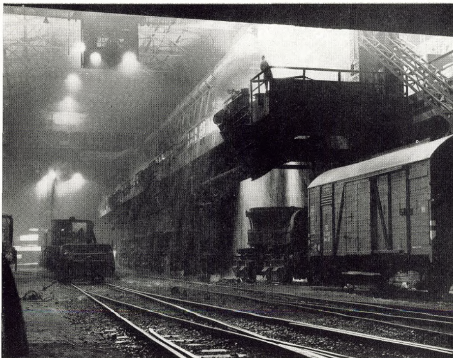
Die Mischeranlage des Thomaswerkes mit ihren drei 1000-Tonnen-Mischern bei Nacht
