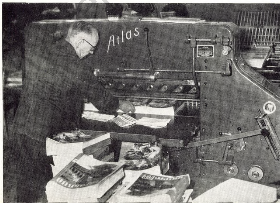
Die fertigen Bogen — bei einem Heft von 24 Seiten, ein Bogen mit sechzehn Seiten und einer mit acht Seiten — werden in der Buchbinderei gefalzt (rechts oben) und danach (mitte rechts) geheftet. Dann gehen sie zum Beschnitt unter eine große Schneidemaschine (unten) und von hier aus durch zahlreiche Hände zum Versand; die Boten warten schon auf die Hefte
