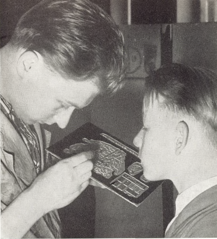
Die Klischee-Herstellung erfordert hohe Sorgfalt. Der Lehrling (oben) beobachtet die Kontrolle einer Strichätzung. Daneben: Eine Autotypie wird mit säurefestem Lack abgedeckt, dann (unten) geätzt, schließlich an der Fräsmaschine (drittes Bild oben) fertig-gemacht. Jetzt hat der „Andrucker“ (ganz unten links) das Wort
