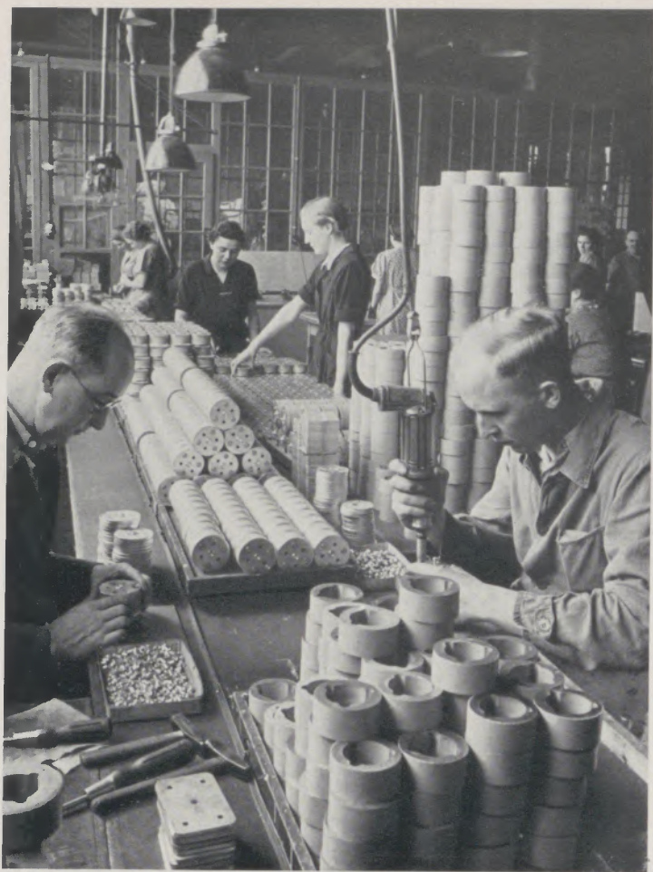
Fließmontage der Ringspaltsysteme
