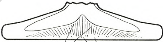
Feinkörnige Oberflächenschicht mit Randblasen
