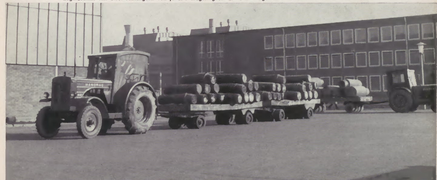
Zugmaschine mit zwei Anhängern von je 20 t Tragfähigkeit auf dem Wege von der Blockdreherei III zum Walzwerk
