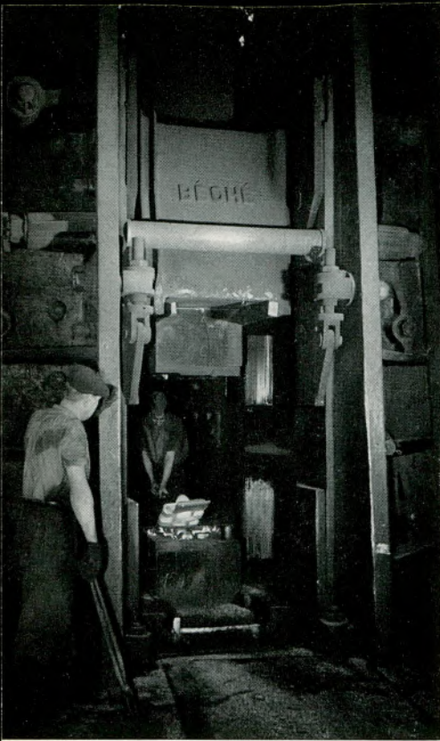
Großer Gesenkschmiedehammer mit einer Arbeitsleistung von 30000 mkg Gesenkschmieden von Fußplatten für Raupenketten
