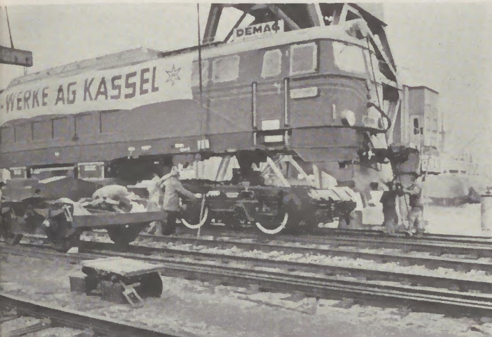
Aufsetzen der Lokomotive auf die Breitspur-Drehgestelle.
