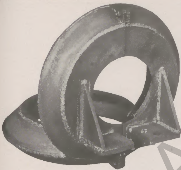
Abb. 94: Elektrisch geschweißtes Schutzgehäuse für einen Regelradantrieb. Ersatz für ein zu Bruch gegangenes Gußgehäuse
