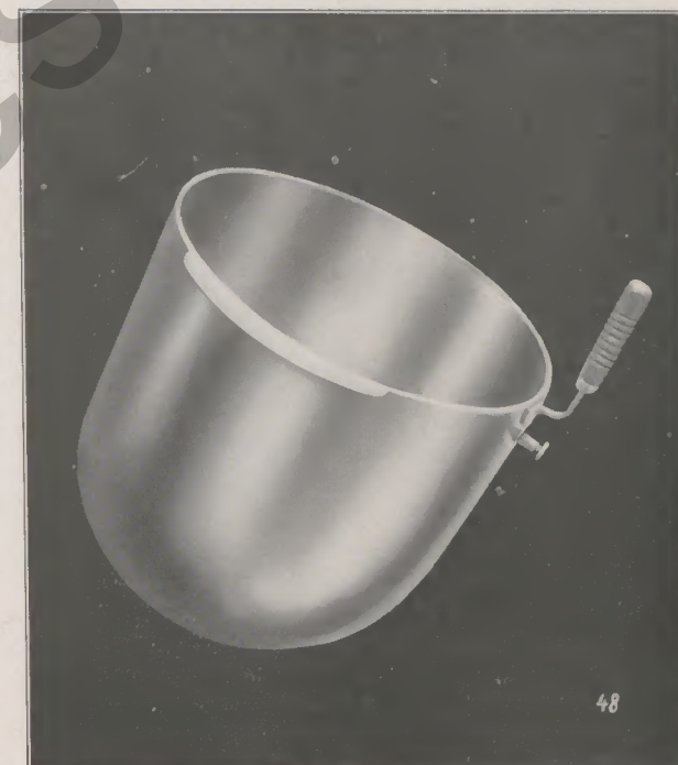
Einsatz für Kippkessel. Der Kessel besteht aus zwei ineinandergefühten Tiefziehkörpern, die oben am Rande miteinander verschweißt sind. In die etwa 10 Millimeter hohle Wand des Kessels wird Dampf zum Erwärmen von Speisen eingeleitet
