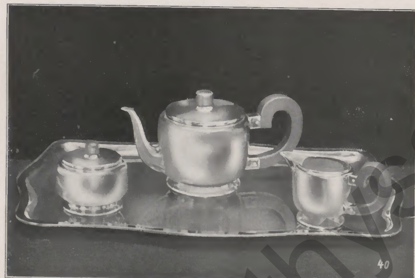
Service, Teile auf der Druckbank von Hand geformt. Ausgüsse und Griffe mit Zinn gelötet
