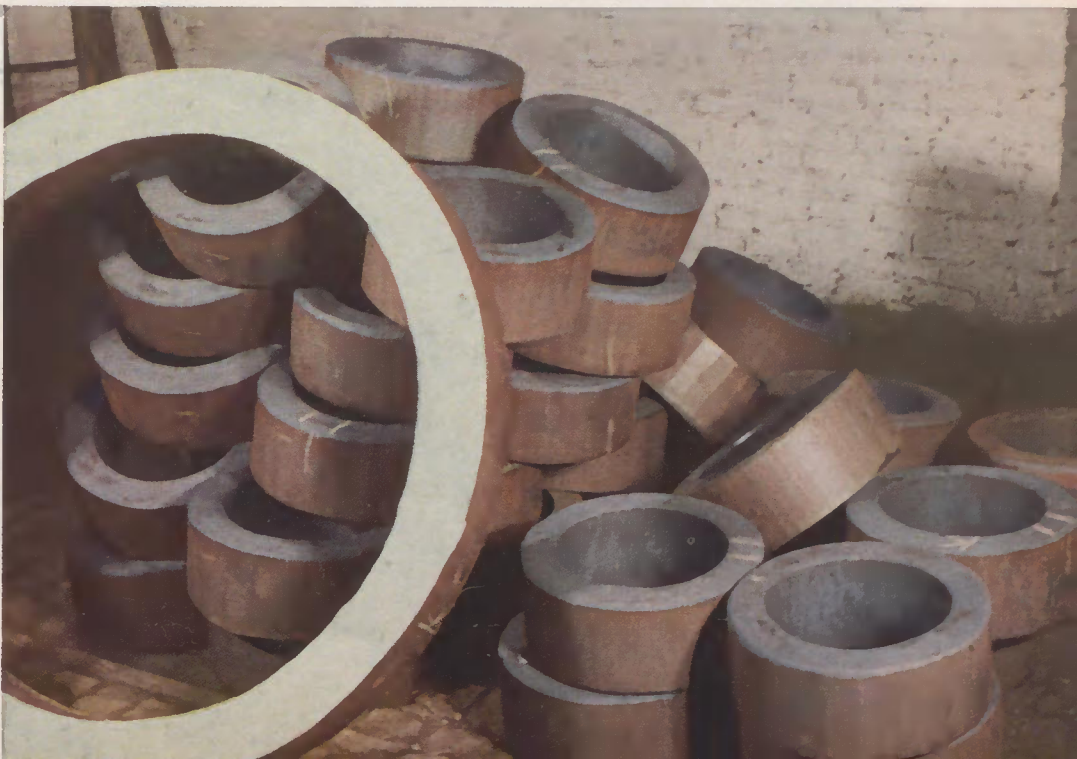
▲ Freiform-Schmieden eines nahtlosen Ringes. Von links nach rechts: Heinrich Neusiß, Karl Schneider, Gerhard Dehnhardt. ▼ Freiform-geschmiedete nahtlose Ringe nach der Kontrolle.
