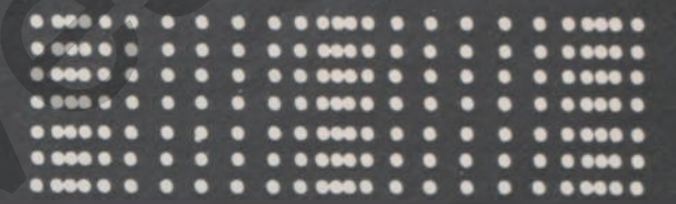
Bewegungszustand der Materieteilchen in einer (longitudinalen) Schallwelle bei dickem Material
