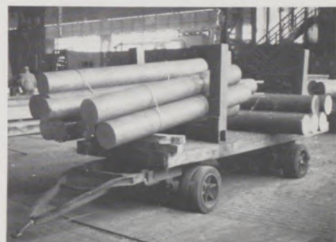
Bild 6: Diese Ladung hält vermutlich schon dem ersten Bahnübergang nicht stand, außerdem schlägt die Deichsel durch.
