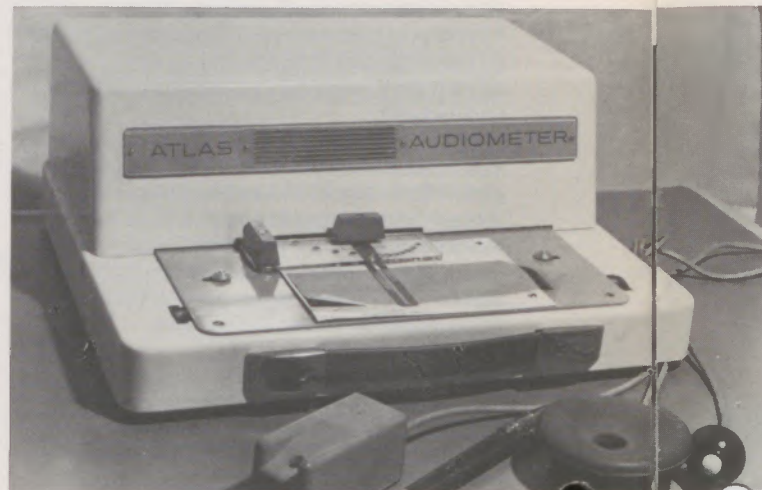
Der Audiometer dient zur Hörschwellenbestimmung.
