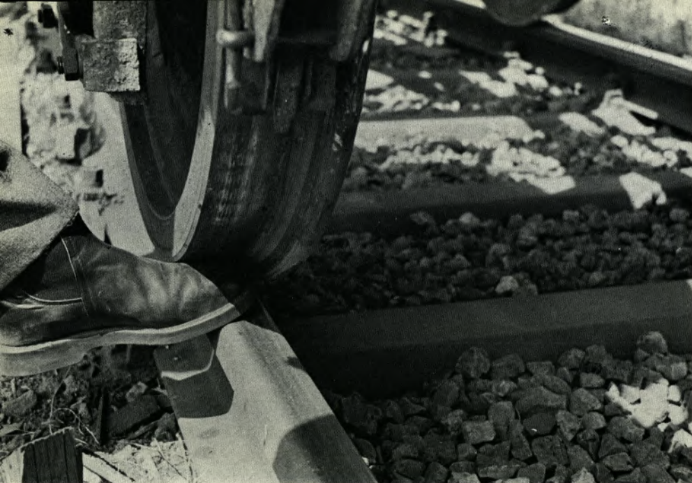
So geriet der Träger des in Bild 4 gezeigten Sicherheitsschuhs unter das Rad des nebenstehenden 100-t-Wagens.
