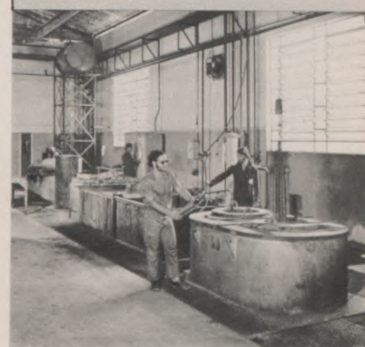
In einer Salzbadanlage werden die Drehstäbe vergütet
