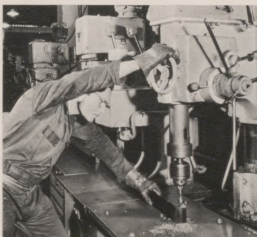
Die Federaugen werden bearbeitet: zunächst aufgefräst, dann wird eine Bronzebüchse eingedrückt, die aufgebohrt wird (unser Bild)
