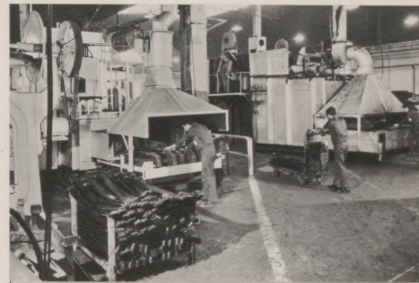
Die gebogenen und gehärteten Blattfederlagen kommen aus dem Anlaßofen (links)
