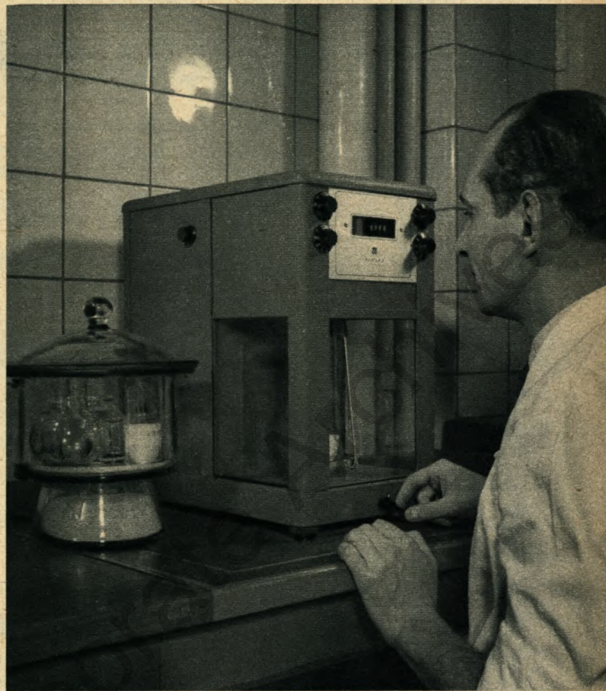
Feinwaage zur Bestimmung minimalster Gewichte bis zu \frac{1}{10\,000} Gramm
