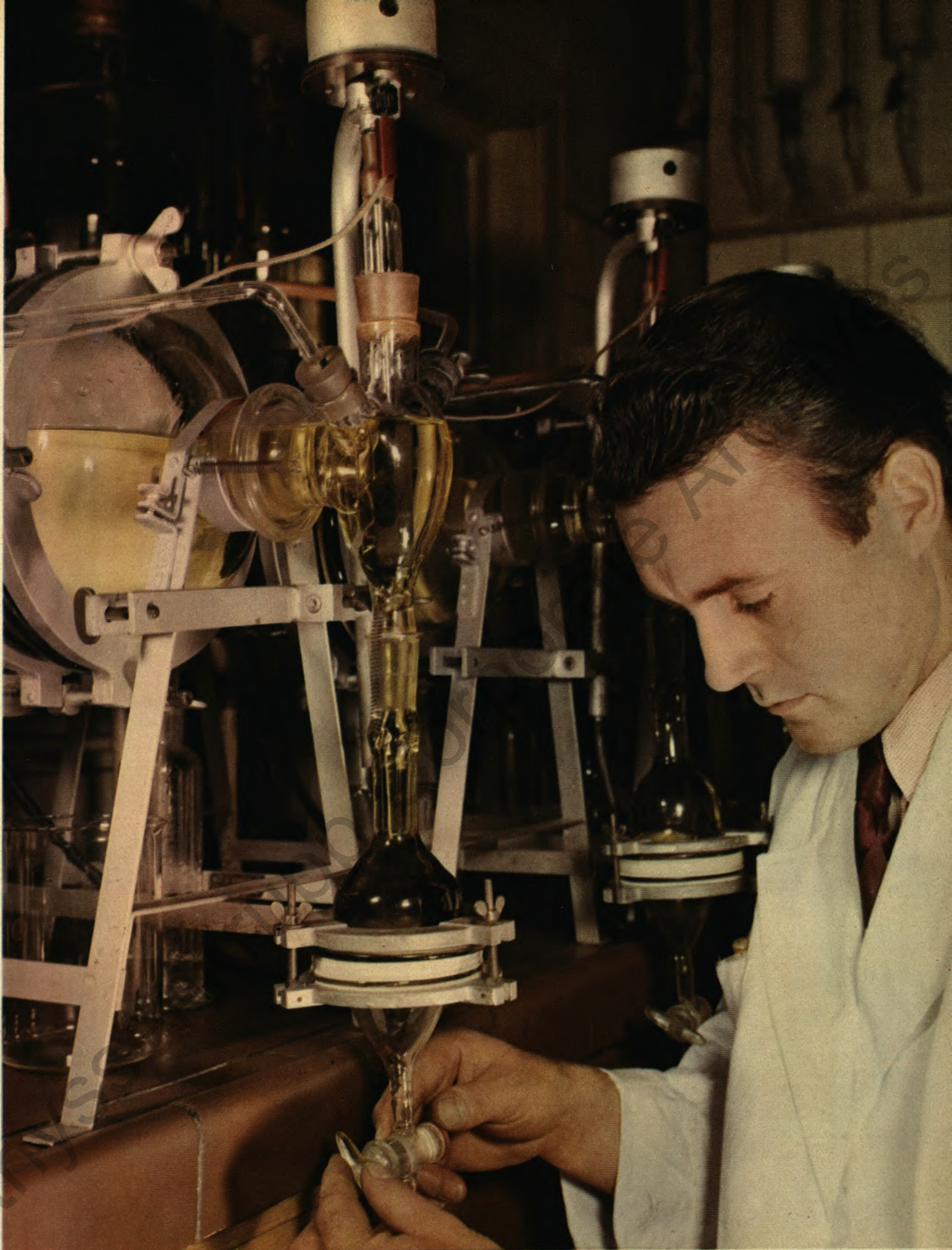
Alfred Meyer bedient ein modernes Analysengerät zur elektrolytischen Isolierung nichtmetallischer Einschlüsse im Stahl
