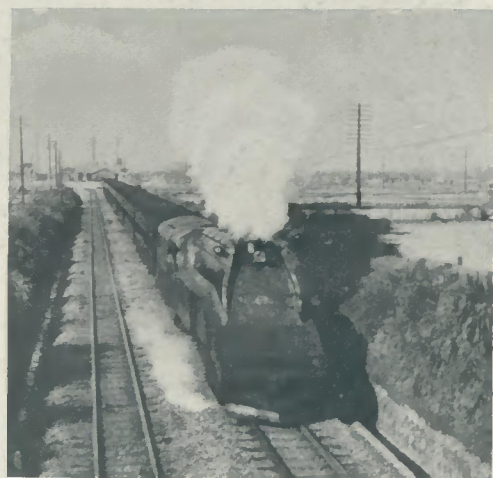
1934 Stromlinienzug der Japanischen Staatsbahnen mit umgebauter 2C1-Lokomotive der Regelbauart, 1067 mm Spur
