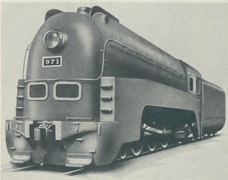
1933 Entwurf eines leichten Dampfzuges mit 2B1-Zwilling-Lokomotive für 160 km/h, Bauart Henschel
