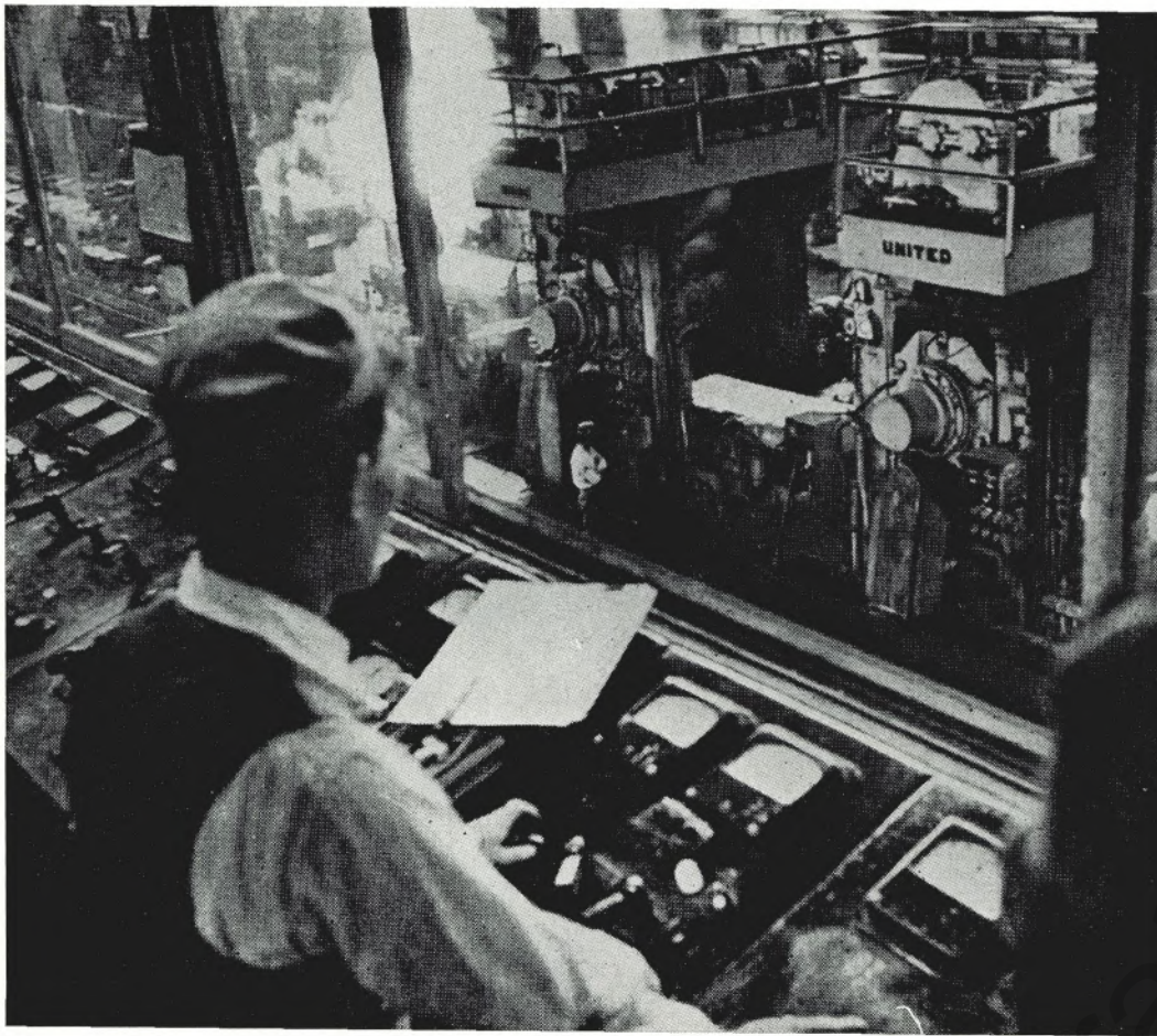
Japanischer Walzer in der Steuerbühne einer von USA gelieferten Breitbandstraße der Yawata Iron & Steel Co
