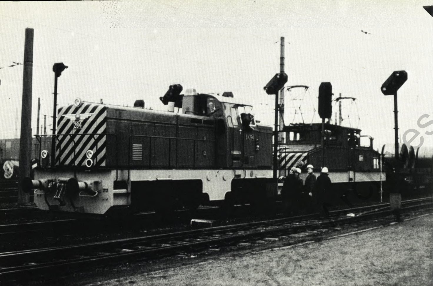
EH 284 und EH 81 – die stärksten Lokomotiven von EH – demonstrieren vor dem Arbeitskreis Maschinenwesen des Unterausschusses Verkehrsbetriebe des VDEh das Anfahren eines 2400 t schweren Zuges im Steigungsbereich unserer Werksanlagen. Jeweils eine Lok mußte den gesamten Zug einschließlich der 2. Lok abziehen.
