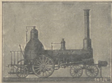
Abb. 5: Personenzuglokomotive für die ehemalige Berlin-Anhalter Eisenbahn, erste von Borsig, Berlin, gebaute Lokomotive, 1841
