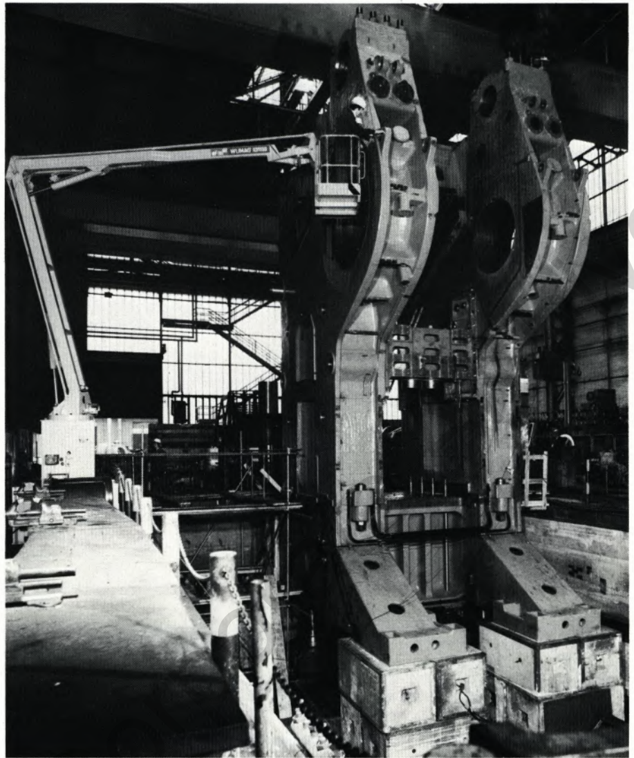
Der Pressenständer bei der Montage in der Weiterbearbeitung der Thyssen Henrichshütte in Hattingen. Das Unterteil und die beiden Seitenteile sind bereits zusammengebaut. Das Oberteil mußte noch aufgesetzt werden, als vor einigen Wochen dieses Foto entstand.
