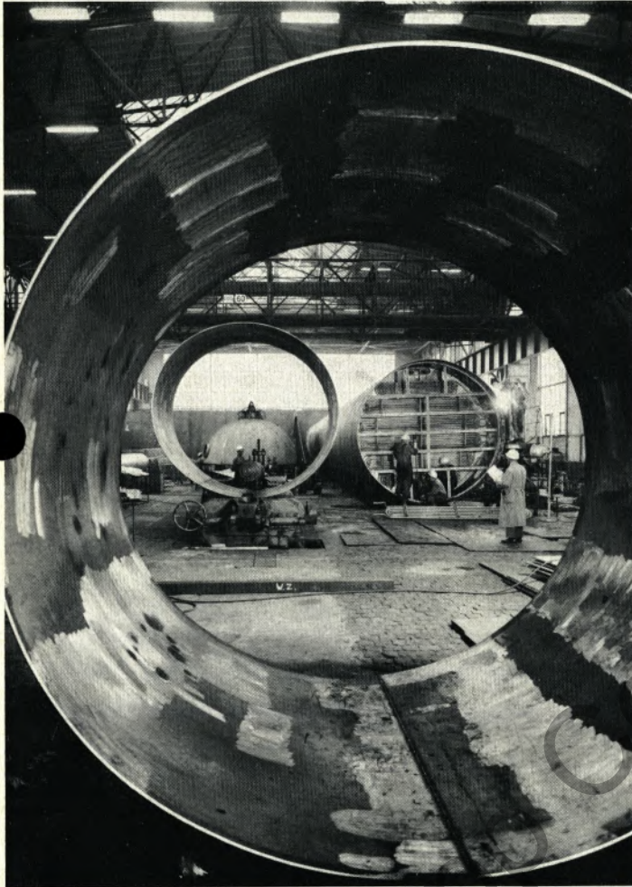
Für eine Salpetersäurefabrik in der Türkei fertigte die Sicromalabteilung in unserem Werk Düsseldorf ihre beiden bisher größten Absorptionskolonnen an.
