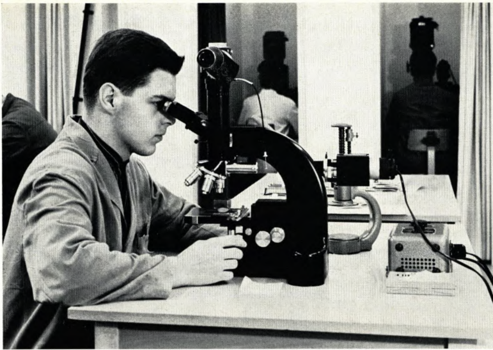
Am Metall-Mikroskop. Im Hintergrund in Kabinen weitere Mikroskope für die metallografische Untersuchung von polierten und geätzten Stahlproben.
