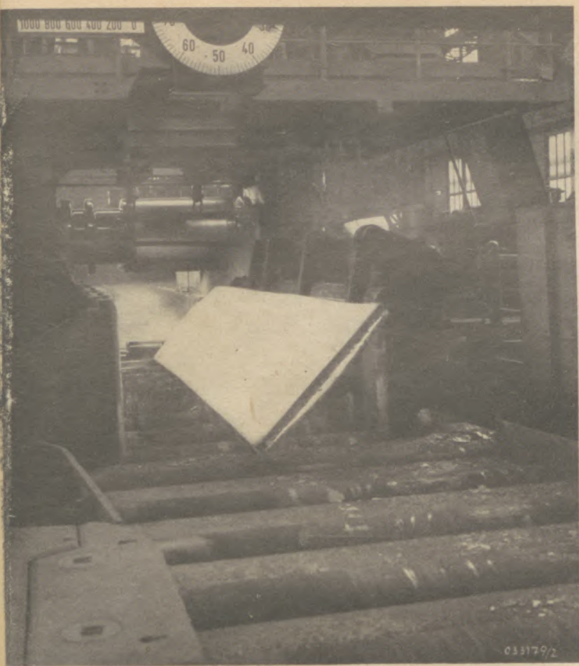
Kanten eines Blockes
