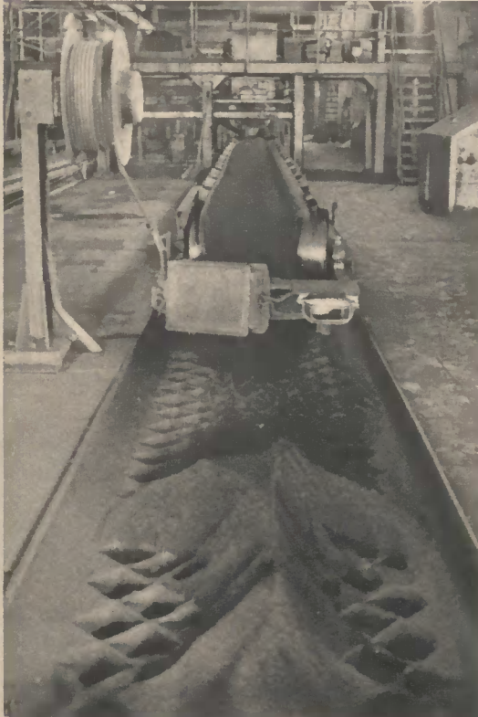
◀ Hier das Förderband, auf dem die Feinkohle von der Wäsche kommt und durch einen Rost in den Bunkern des Kraftwerkes Leopold verschwindet
