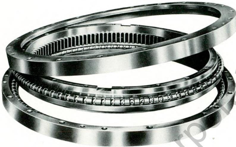
Abbildung 2 Zweireihige, dreiteilige Kugel-Drehverbindung mit Innenverzahnung. Die Kugeln werden durch Zwischenstücke auf Abstand gehalten.
