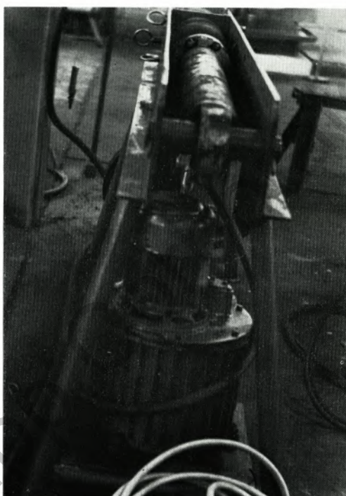
Die Mitarbeiter Hans Gerdes und Horst Thimm, beide Hafenbetrieb, konstruierten ein Gerät zum Ab- und Aufdrücken der Förderband-Scheibenträgrollen, das hier auch in Aktion gezeigt wird.
