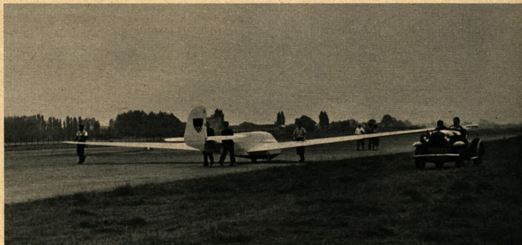
Heinz Themat und Friedhelm Nickel an der Winde. Sie ist nach Plänen von Heinz Themat auf einem alten amerikanischen Militärlaster montiert worden. Mit 140 PS zieht sie das Segelflugzeug in die Lüfte
