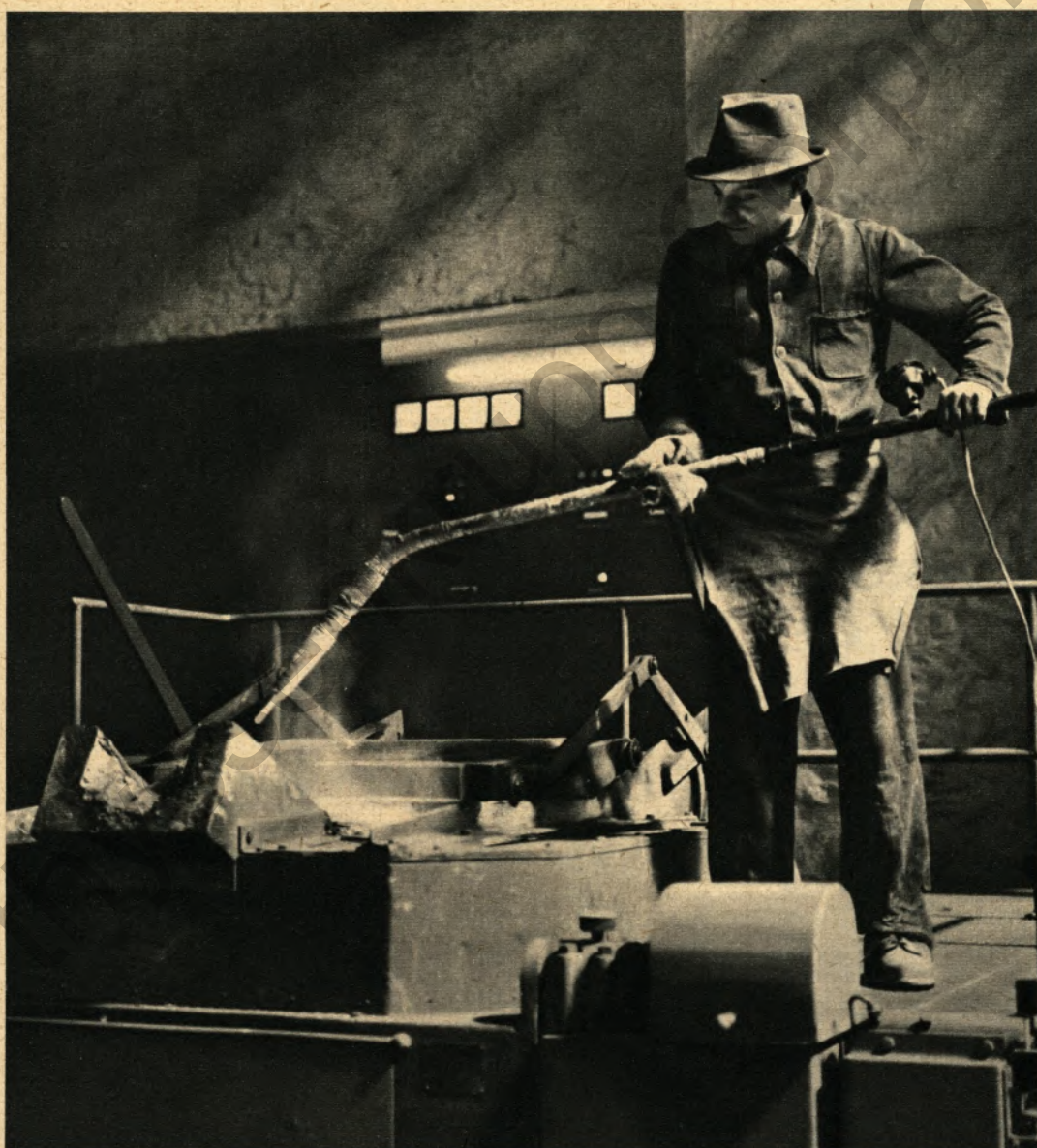
Leo Krumrey senkt das Tauchthermoelement in den tiegelförmigen Elektroofen, um die Temperatur des flüssigen Eisens zu messen
