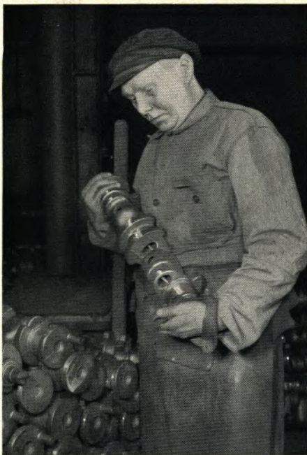
Heinrich Dickel kontrolliert im Werk Werdohl der Schmiedag jede Sphäroguß-Kurbelwelle, bevor sie das Werk verläßt
