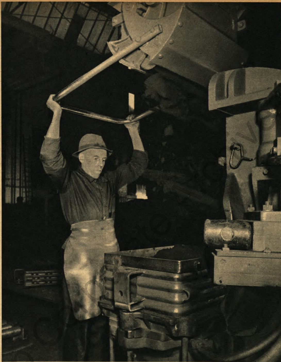
Abstich des Elektroofens. Die gewünschte Temperatur ist erreicht – das Eisen fließt in die Behandlungspfanne
