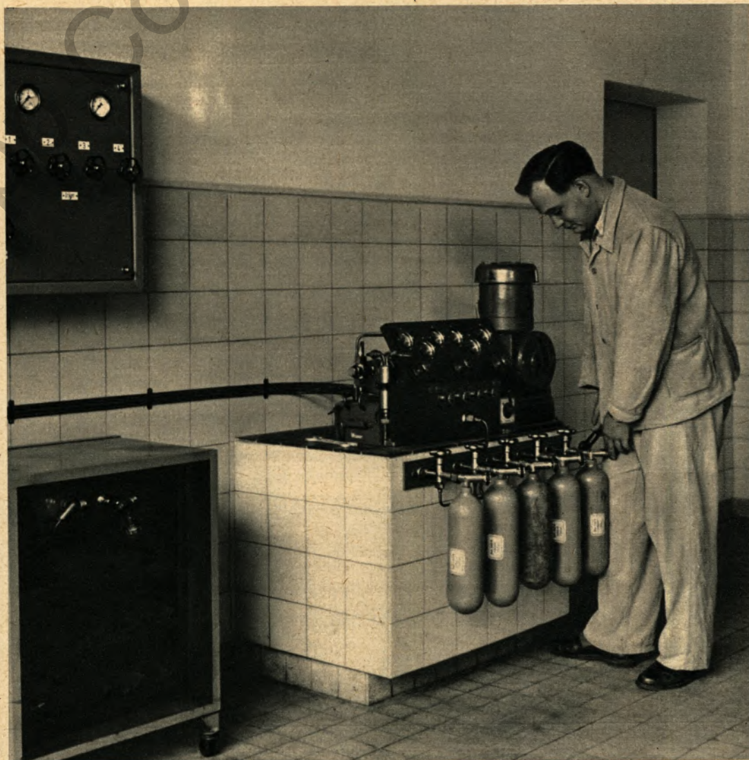
Gerätewart Anton Meierhoff füllt die leeren Sauerstoffflaschen der Sauerstoffkreislaufgeräte an der Umfüllanlage auf
