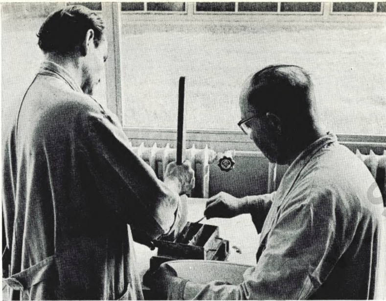
Die Zementproben werden mit besonderem Normensand und Wasser (links) zu Zementmörtel gemischt und dann (rechts) in Prismenformen zu Betonproben eingestampft
