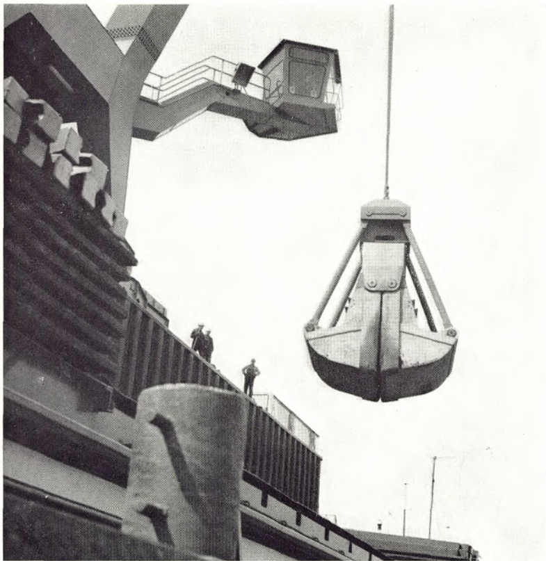
Oben: Der Kranführer der Schiffsentlade-Anlage bedient von seinem über das Wasser hinaus ragenden Steuerstand den Greifer, der mit jedem Hub zwölf Tonnen Erz in einem Bunker fördert (unten links), aus dem das Erz in gleichmäßigem Fluß über ein Plattenband (Mitte) der Bandanlage übergeben wird. Das Bild unten rechts zeigt den Verteiler Nord, von dem aus drei Bänder zur Eckstation West (im Vordergrund) und von da zum Erzlager bzw. zur Erzbrech- und -Siebanlage führen
