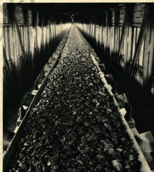
▲ Aber nicht nur unter Tage, auch über Tage fallen Berge an. In ununterbrochenem Strom kommen sie von der Wäsche, wo sie in Setzmaschinen von der reinen Kohle getrennt worden sind
