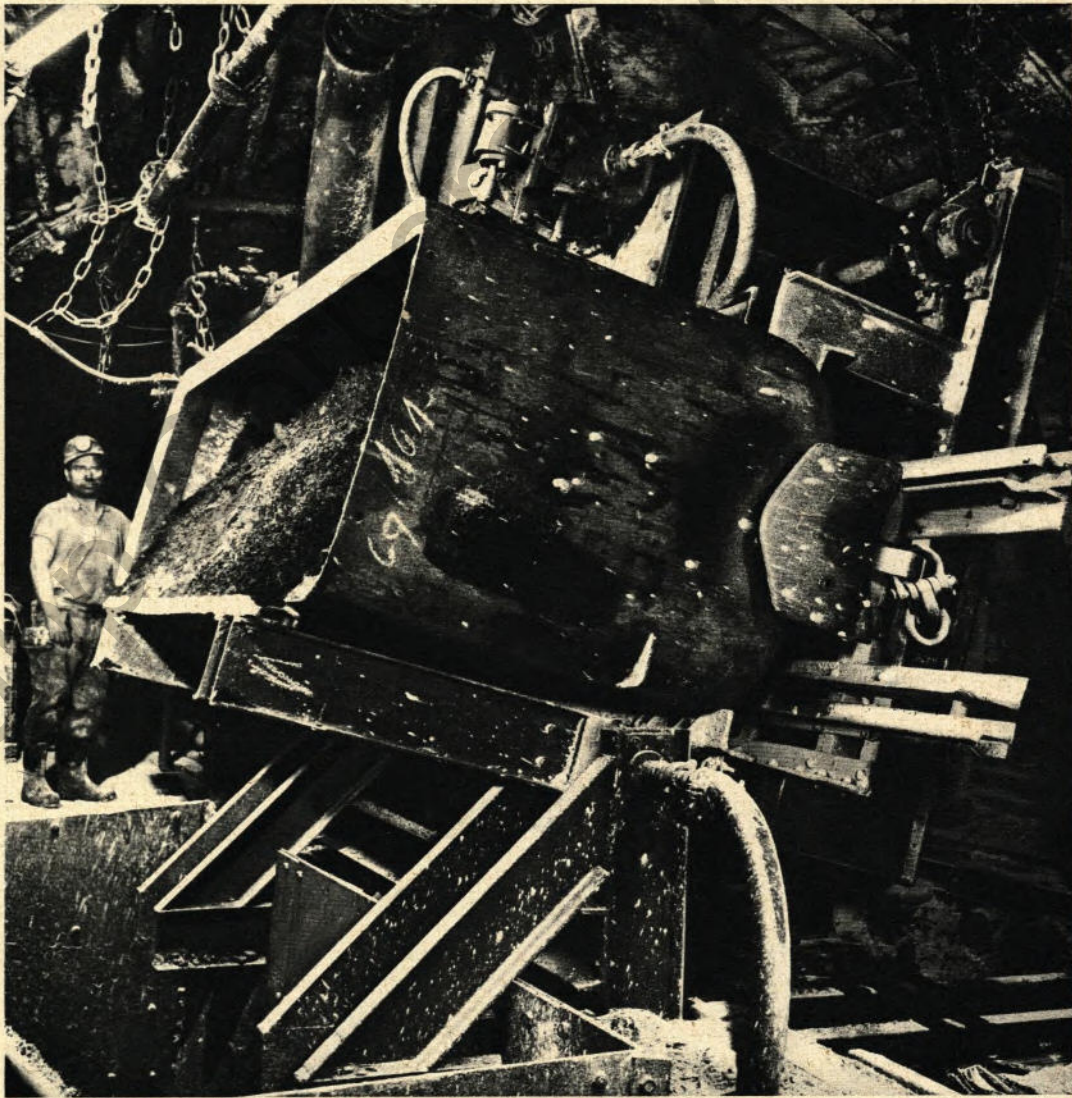
▲ Preßluftlokomotiven ziehen die Bergzüge über die Hauptstrecken in die Abteilungsquerschläge. Hier werden die Wagen abgekuppelt und in Kippen entleert
