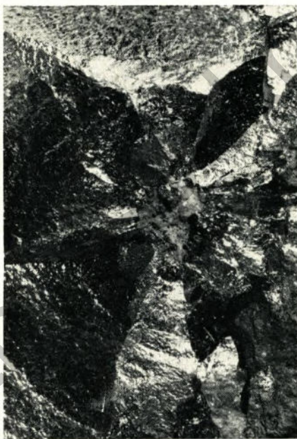
Rückseite: Das Bild zeigt in starker Vergrößerung die Oberfläche eines Stückes Rohreisen. Die Farberscheinungen, als Anlauf-farben bezeichnet, entstehen durch Lichtbrechung und Reflexion innerhalb sehr dünner, durchsichtiger Oxydschichten, die sich auf der Oberfläche gebildet haben
