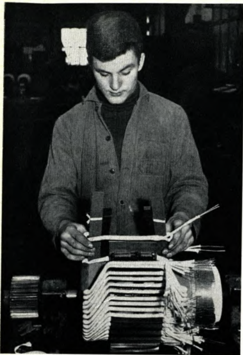
Der Lehrling legt die Formspulen mit den erforderlichen Isolierbeilagen in die Nuten des Ankers
