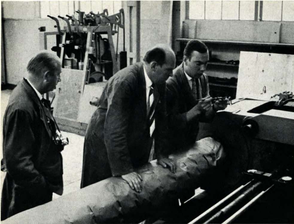
In einer liegenden Zerreißmaschine mit 750 Tonnen Zerreißlast wurde im Seilprüfraum des Werkes Lippstadt ein 4 Meter langes Prüfstück aus der Fabrikationslänge der für die Autobahnbrücke Leverkusen gefertigten Seile einer sich über Stunden erstreckenden Spannungs-Dehnungs-Probe unterworfen. Die eingebauten Meßuhren zur Ermittlung der jeweiligen Seildehnung in Abhängigkeit von der Spannung zeigten das Verhalten des Brückenseiles bei den wechselnden Belastungen an, die auf der Brücke zukünftig auftreten können.
