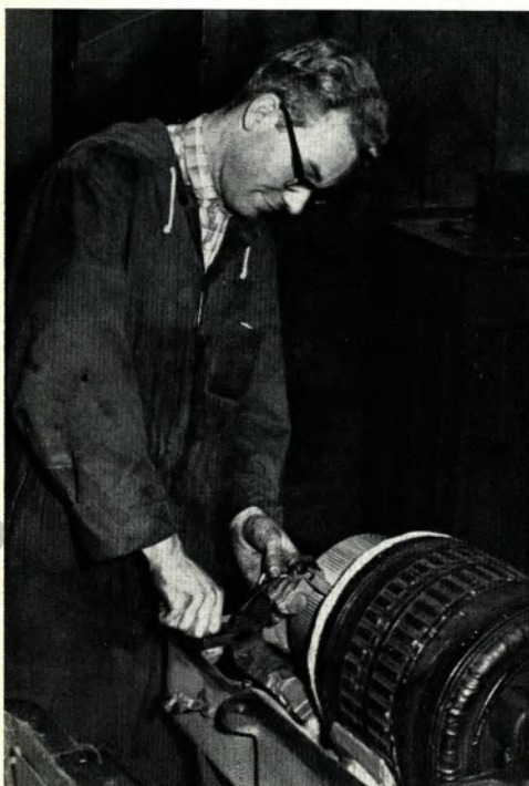
Der fertige Anker wird in das Motorengehäuse eingesetzt; der Lehrling setzt gerade die Stromabnehmerbürsten — das Bürstenjoch — auf
