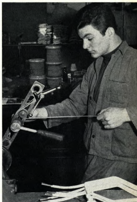
Die Ankerspulen werden in einer besonderen Vorrichtung gewickelt und geformt
