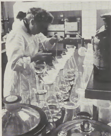
Erz im Reagenzglas: Von jeder Erzlieferung werden verschiedene Proben genommen und in einer Gemeinschaftsprobe auf 16 Elemente untersucht. Die Untersuchung auf Tonerde durch die Laborantin Gerda Schulte bildet nur einen kleinen Teil dieser Probe
