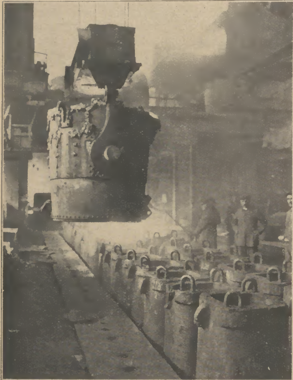
Aus unserm Martinstahlwerk. Gießen in Blockformen.
