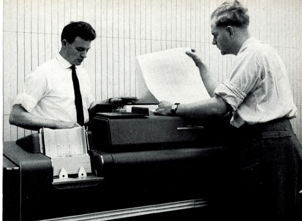
Dieser Drucker 407 gehört zur neuen Rechenanlage. Einer der beiden IBM-Techniker kontrolliert die ersten Listen, die der Drucker diese Maschine automatisch ausgeschrieben hat. Links vorne werden Lochkarten eingegeben. Der Drucker 407 kann unabhängig oder im Zusammenhang mit der Rechenanlage eingesetzt werden.
