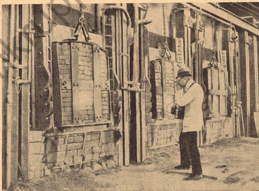
Abb. 2. Messung der Temperatur im Innern eines Schmelzofens durch das Schauloch
