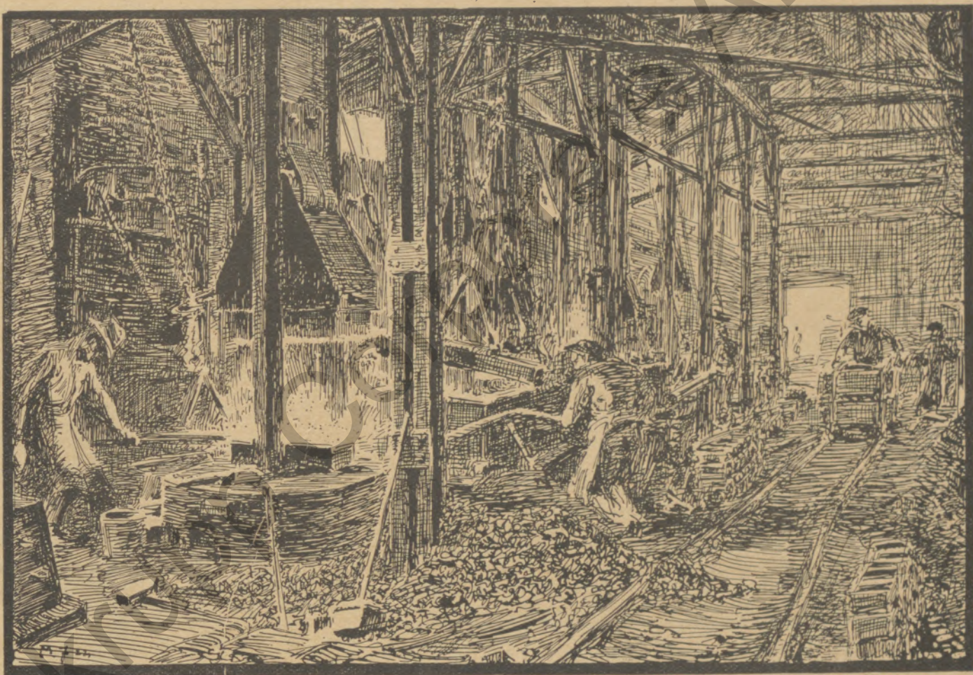
Federhammerschmiede für Gabeln.
