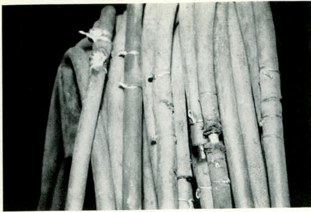
Ein Gasschlauch, der vielfach unsachgemäß geflickt wurde. Schläuche dieser Art sind unbrauchbar.
