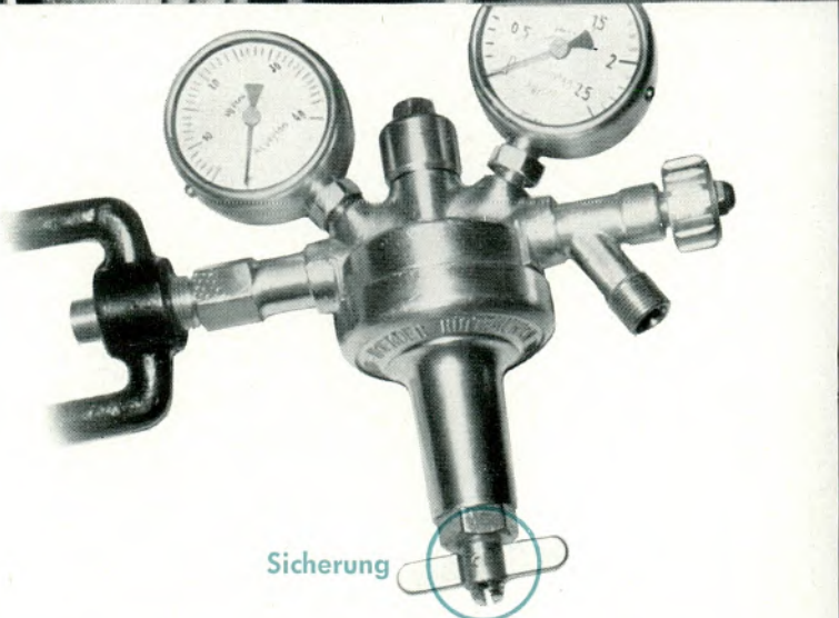
Bei Druckminderern für Azetylen, die nach dem 1. Januar 1954 neu in Betrieb genommen werden, darf kein höherer Arbeitsdruck als 1,5 atü einstellbar sein. Die Sicherung an der aufgeschlitzten Einstellvorrichtung ist deutlich zu erkennen.
