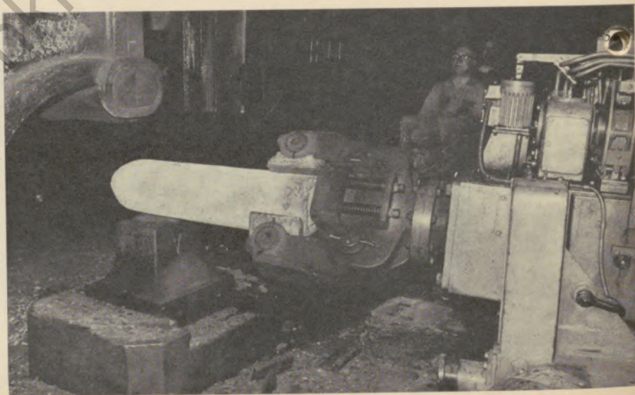
Manipulator bei schwerer Schmiedearbeit
