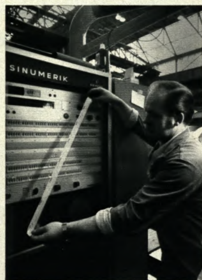
▲ Der Lochstreifen, der alle Arbeitsoperationen der Maschine gespeichert hat, wird in den Steuerschrank eingelegt
