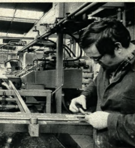
▲ Klemens Heite an der Schälmaschine für Rundstäbe, dem Vormaterial für Stabilisatoren und Drehstabfedern
