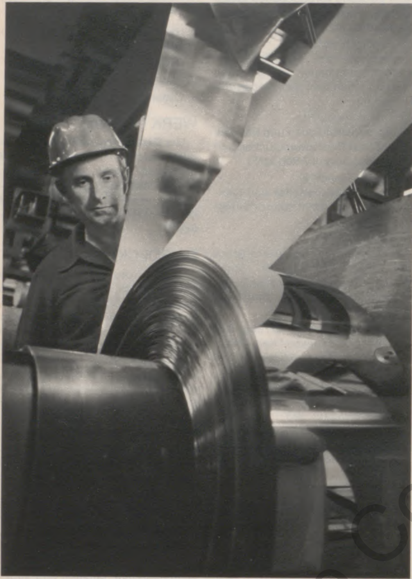
▲ Im vorigen Jahr ging im Werk Trier die neue elektrolytische Veredlungsanlage in Betrieb, in der Stahlband mit verschiedenen Metallen beschichtet wird. Unsere Aufnahme zeigt Alfons Hommes, der fertiges Band beim Aufhaspeln beobachtet
