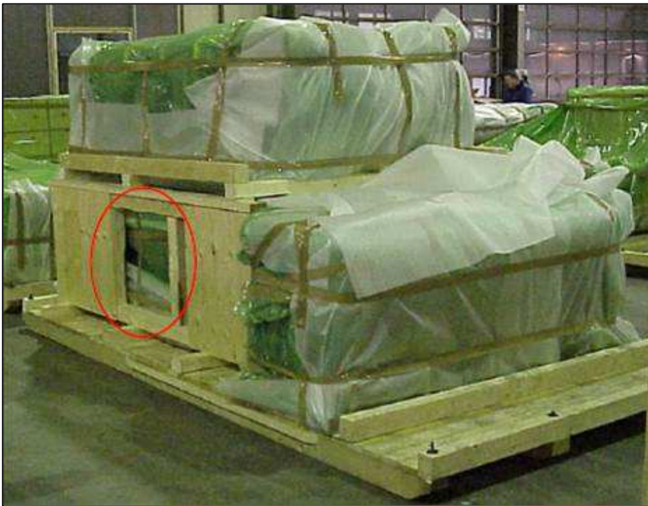
Stabiler Unterbau (Unterkonstruktion) mit Hölzern 10 cm x 10 cm
