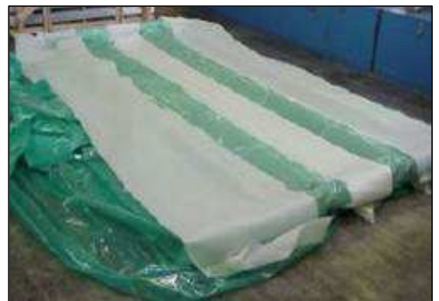
Die Auflagestellen für die Packstücke werden nochmals mit Polsterfolie belegt
