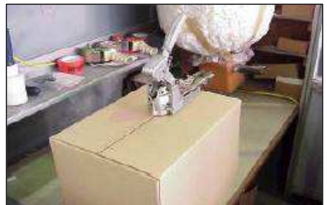
Bei höherem Gewicht auch den Deckel klammern!
