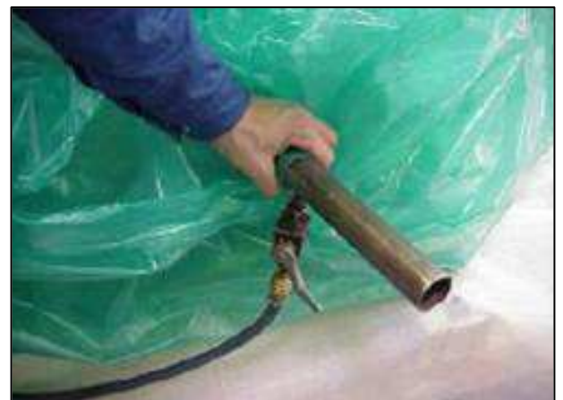
Ein Teil der Luft wird abgesaugt, um den Sättigungsdampfdruck der VCI-Gase zu erhöhen. Anschließend wird die Öffnung verschweißt.
