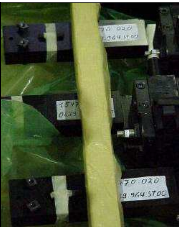
Kontakt zwischen Holz und Metall vermeiden, da das Metall durch die Restfeuchte im Holz korrodiert.
