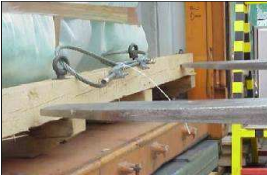
Eine Stahlschleife anbringen, um die Plattform aus dem Container zu ziehen.
