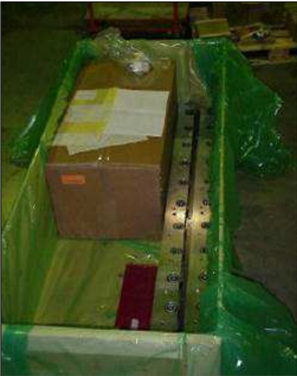
Die Kiste wird mit VCI-Folie ausgekleidet. Konservierung der Metallteile durch VCI-Öl oder WD40
