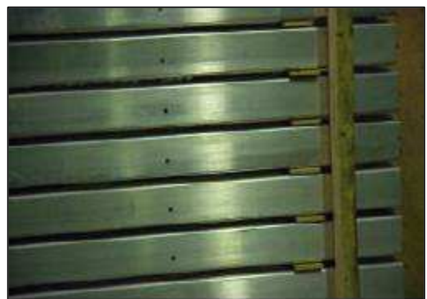
Sorgfältige Schichtung mit Zwischenhölzern
