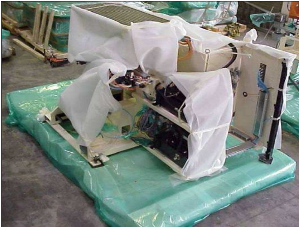
Ecken und Kanten mit Polsterfolie abgedeckt
