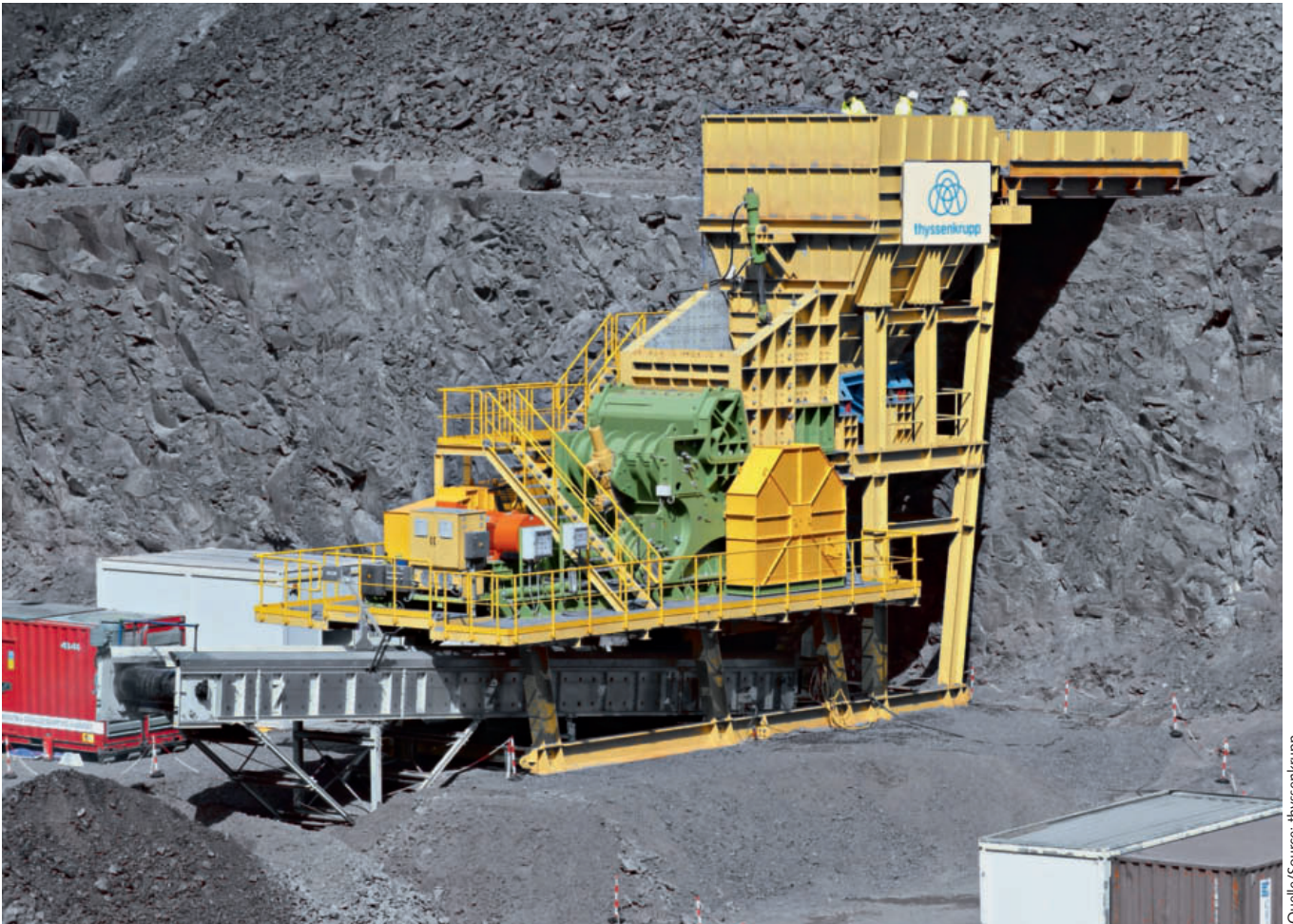
Testanlage mit dem Exzenterwalzenbrecher • Test plant with the eccentric roll crusher
