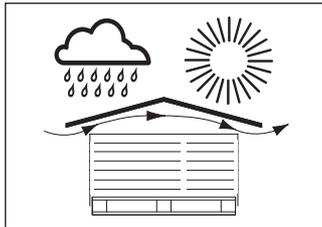
Stapel unter Dach oder mit Planen abgedeckt vor Nässe und direkter Sonneneinstrahlung schützen. Die Schutzfolie allein genügt nicht.
