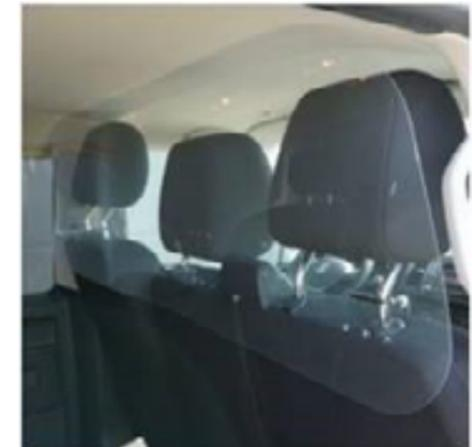
Les matières facilement usinables comme le polycarbonate ou le PMMA permettent des découpes plus complexes avec des arrondis. Voici un exemple de réalisation pour une société de taxis.
