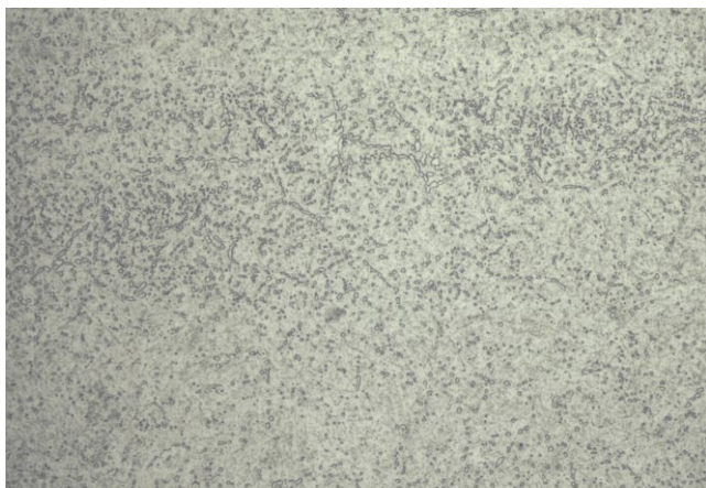
THYROPLAST-2083 ESU SUPRA Inhomogene, ungleichmässige Karbidverteilung
