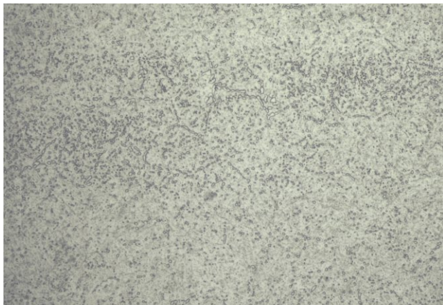
THYROPLAST-2083 ESU SUPRA Inhomogene, ungleichmässige Karbidverteilung
