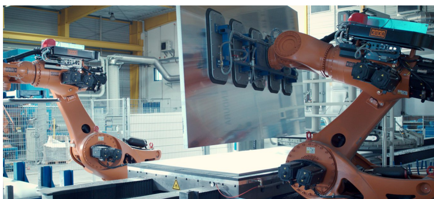
Roboter übernehmen die Bestückung von Bearbeitungsmaschinen
