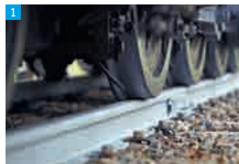
1: Hluk jízdy vyvolaný odvalováním kola po kolejnici
