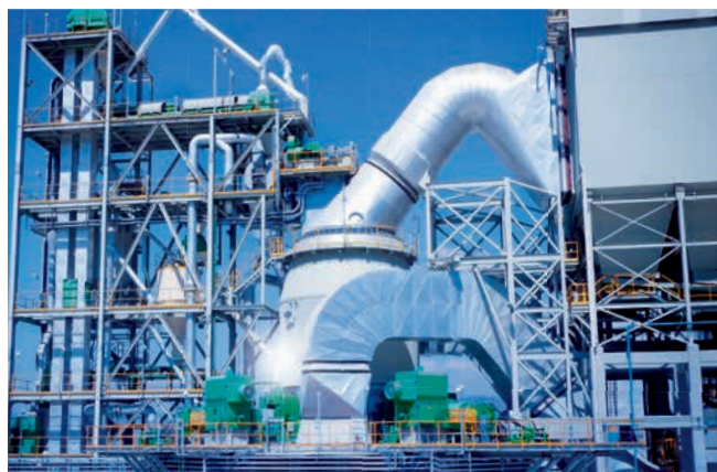
Le plus grand broyeur QMC²-RD, d'une puissance de 4 x 1.800 kilowatt et d'une capacité de 300 tonnes par heure, se trouve au Mexique.
