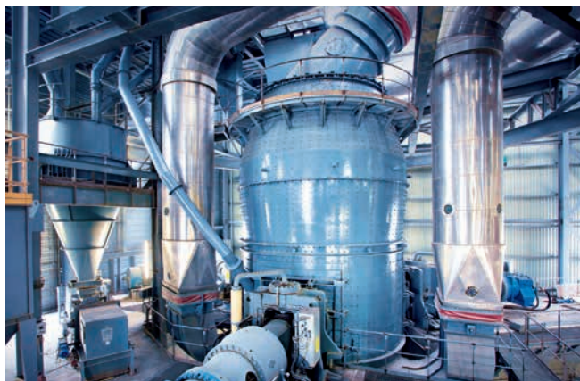
Un QMC²-RD en France: il produit du ciment OPC d'une finesse de < 10 % R 25 µm.
