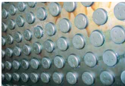
Walzenkörper mit Hartmetall-Stiften für geringen Instandhaltungsaufwand
