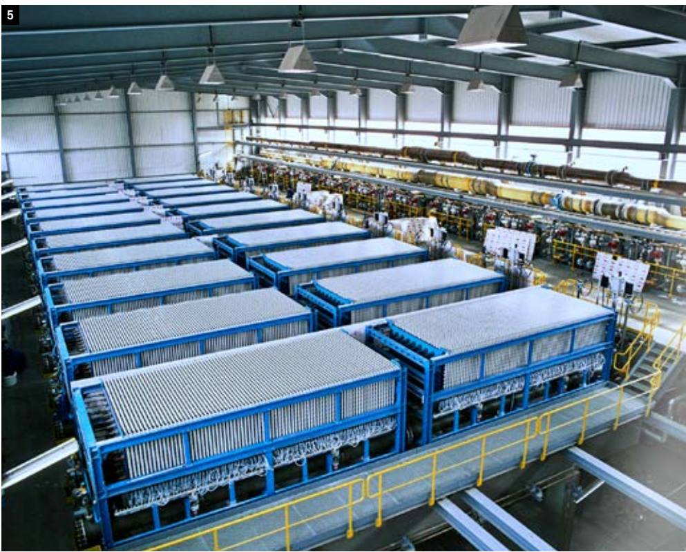
5 Cell house in Tessenderlo, Belgium (272,000 mt/year chlorine). If you compare today's electrolysis plants with our Tofte project in the past, you can see that the plants are worlds apart. With the latest generations of membrane electrolysis technology (BM single element, which is used in Tessenderlo) and BiTAC (filter press technology), energy consumption can even be reduced to less than 2,000 kWh/t NaOH at 6kA/m 2 . This is the result of continuous research and development. | Zellensaal Tessenderlo, Belgien (272.000 t/Jahr Chlor). Beim Vergleich der heutigen Elektrolyse-Anlagen mit dem damaligen Projekt Tofte zeigt sich: Dazwischen liegen Welten. In den neuesten Generationen von Membranelektrolyse (BM single element, die in Tessenderlo zum Einsatz kommt) und BiTAC (Filterpressen-Technologie) kann der Energieverbrauch sogar auf unter 2.000 kWh/t NaOH bei 6kA/m 2 gesenkt werden. Das Ergebnis kontinuierlicher Forschung und Entwicklung.
