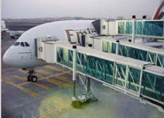
Neue, in der Höhe verstellbare Apron Drive-Bridge für den Airbus A380
